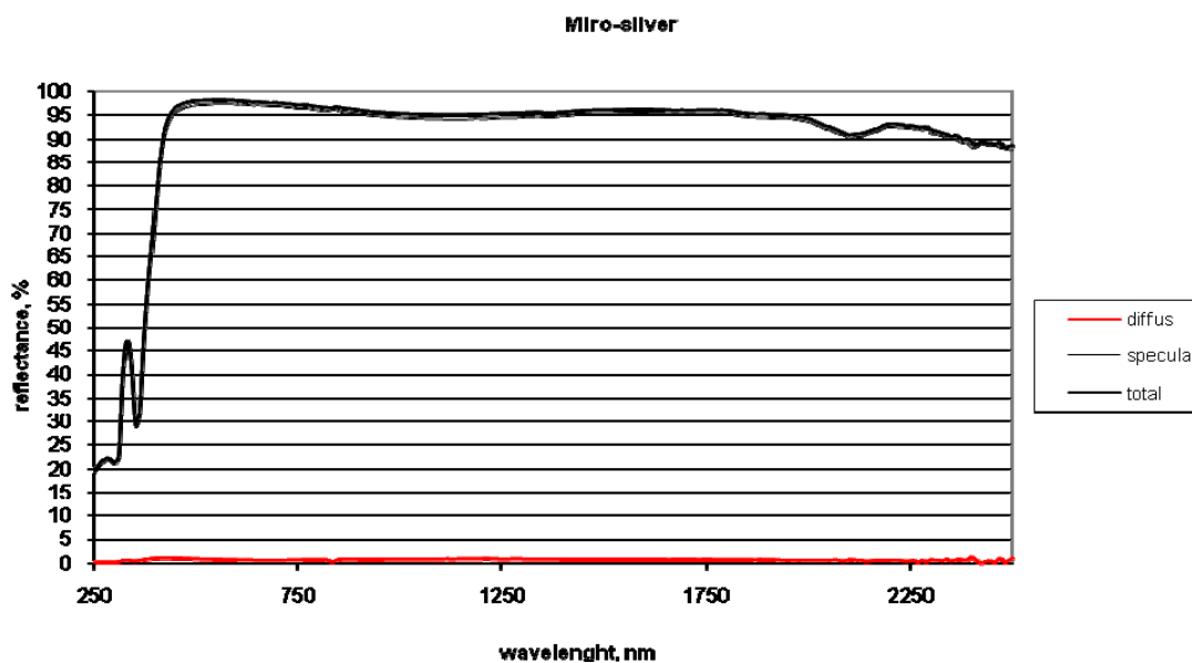
Рис. 4 – Спектральная отражательная способность плоского отражателя из материала Miro-Silver 4270 AG ( h=200 мкм) компании ALANOD (Германия)
