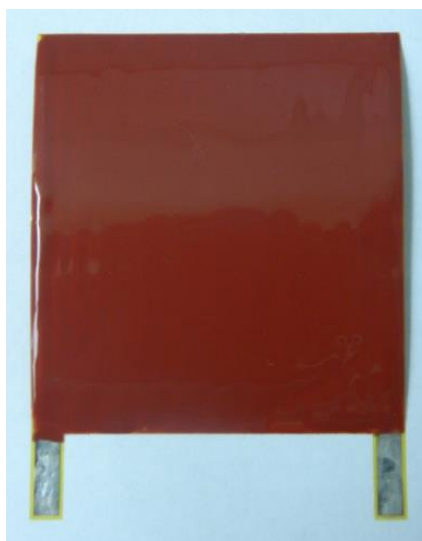
Рис. 6 –Тестовый технологический образец электронагревателя с защитным покрытием
