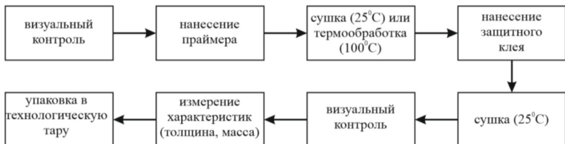
Рис. 5 – Технологическая схема формирования защитного покрытия электронагревателя
