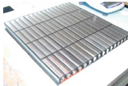
Макетный образец солнечного концентраторного модуля на линейных линзах Френеля разработки ГП НИТИП, Харьков, Украина, 2013 г.
